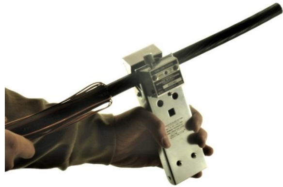
Figure 12: Adjust the semi-con layer per the template.
